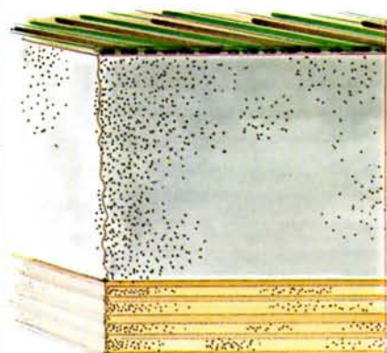
Polsterquerschnitt einschließlich Auflagebrett aus Sperrholz
